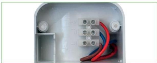
Bornas para la conexión del cableado.
